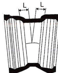
雙頭承插11.25°彎管 Double Socket 11.25° Bend
